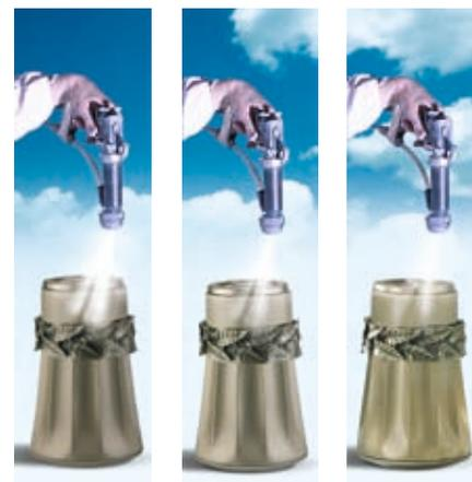
Il nostro innovativo sistema di verniciatura ci permette di dare, in modo molto preciso, ben 4 strati di vernice anticorrosiva, la stessa usata anche nell'industria automobilistica.
